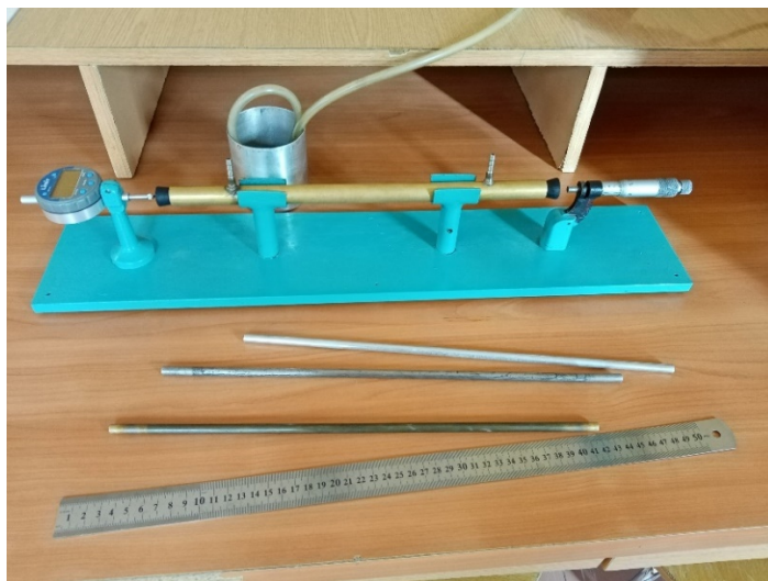
Rys. 1. Fotografia przedstawiająca elementy stanowiska do badań z widocznym na drugim planie dylatometrem.
